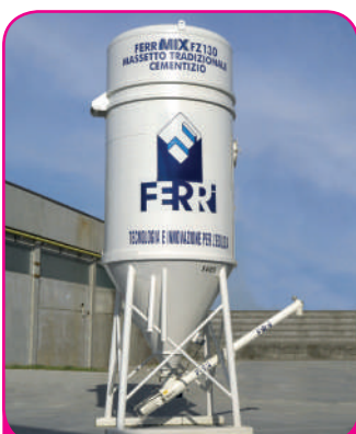
SILOS DI STOCCAGGIO DEL MASSETTO
